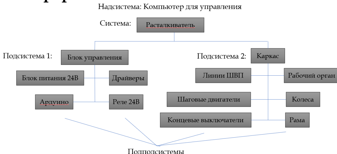
Рисунок 3.1 – Иерархия системы управления РТК «Расталкивателя»
